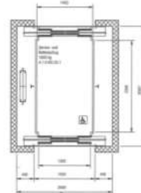
grosser Betten- und Warenaufzug, zweiseitig
