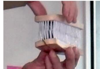
Nun versucht man, die obere Bürste horizontal wegzuziehen. Man braucht hierzu eine relativ große Kraft. Gleitet die obere Bürste bereits mit konstanter Geschwindigkeit über die untere, so ist die aufzuwendende Kraft deutlich kleiner.
