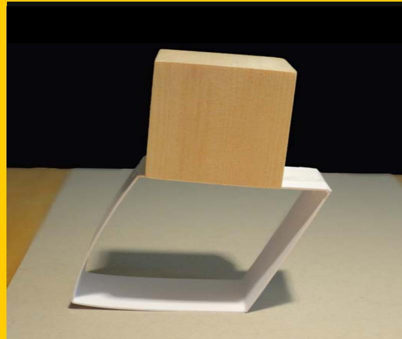
Material: Kartonstreifen 10 x 40 cm, falten in 10 cm Abständen, mit Klebeband verbinden
