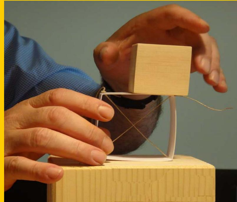
Material: Kartonstreifen 10 x 40 cm, falten in 10 cm Abständen, mit Klebeband verbinden, Schnur
