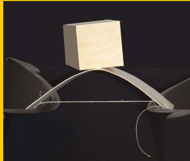
Material: Kartonstreifen 20 x 6 cm, Schnur, Holzblock zur Belastungsprobe
